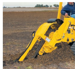
Der Fräsausleger kann bis zu 152,4 cm tief und 30,5 cm breit fräsen. Er wird hydrostatisch angetrieben.
