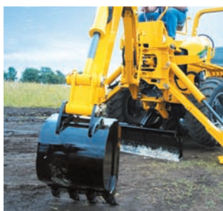
Der Baggeranbau hat eine maximale Grabtiefe von 245,9 cm und einen Schwenkbereich von 170°.
