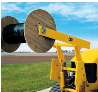
Die Kabeleinzugsvorrichtung hat eine Tragkraft von 680,4 kg.
