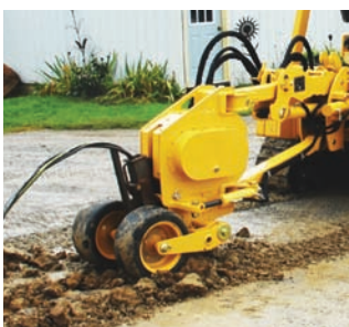
Der Vibrationspflug mit einer maximalen Rüttelkraft von 10.886 kg und einem Drehwinkel von 30° kann bis zu 91 cm tief pflügen.
