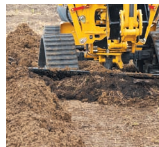
Das Rückfüllschild mit 30° Schwenkbereich und einem Neigungswinkel von 12° ist mit Quad-Raupen 201 cm breit.
